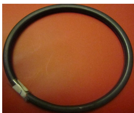
شکل ۶. تصویر اورینگ ساخته شده از آمیزه تکنوفلون PFR95T با پخت اصلاح شده پس از ۱۳ ساعت اعمال شرایط عملیاتی در آزمون کاربردی (نشست نمونه بر اثر مانایی فشاری بالا) (بزرگنمایی ۱X)
