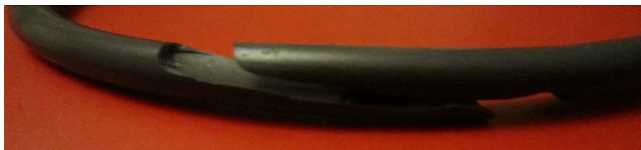
شکل ۵. تصویر نقیصه روزن رانی در اورینگ ساخته شده از آمیزه تکنوفلون PFR95T پس از ۳ ساعت اعمال شرایط عملیاتی در آزمون کاربردی (بزرگنمایی ۱X)
