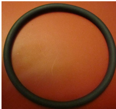
شکل ۸. تصویر اورینگ‌های کالرز ۰۰۹۰ با مانایی مناسب (بزرگنمایی ۱X)
