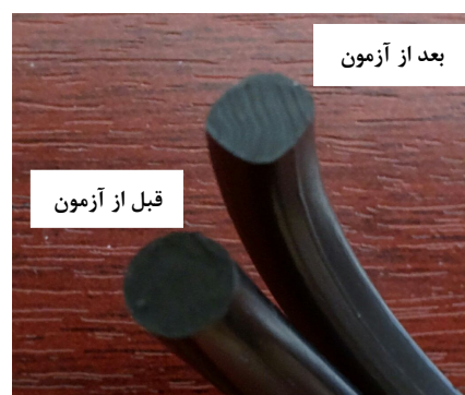
شکل ۶. تصویر اورینگ ساخته شده از آمیزه تکنوفلون PFR95T با پخت اصلاح شده پس از ۱۳ ساعت اعمال شرایط عملیاتی در آزمون کاربردی (نشست نمونه بر اثر مانایی فشاری بالا) (بزرگنمایی ۱X)
