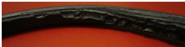
شکل ۴. تصویر ترک‌های سطحی اورینگ ساخته شده از آمیزه تکنوفلون PFR95T پس از ۳ ساعت اعمال شرایط عملیاتی در آزمون کاربردی (بزرگنمایی ۱X)
